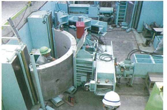
継手曲げ試験載荷状況
