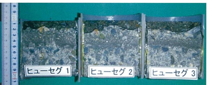
透水試験結果(インプット法:1MPa、24時間)
