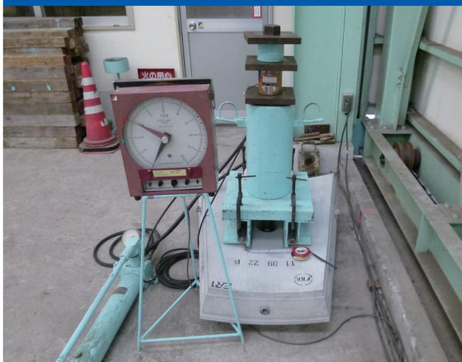
目的 セグメント組立時に使用する吊り手金具の引抜強度確認
