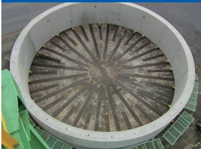
目的 型枠精度、ボルトピッチ、セグメント継手の平滑性、寸法等を総合的に調べる検査
