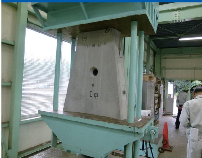
目的 シールド推進時、ジャッキ推力のセグメント耐荷力確認
